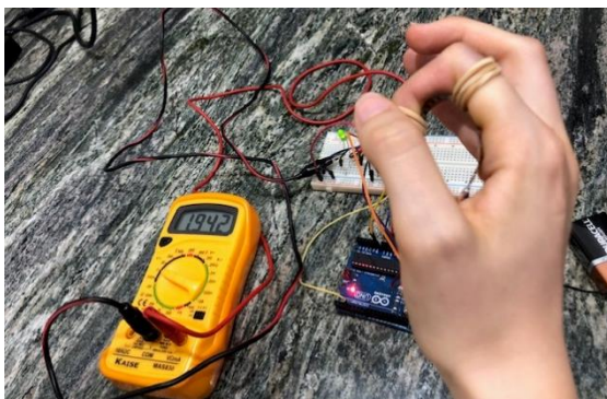
Imatge 91: Valor del voltatge amb el flex sensor unit al meu dit. Font: pròpia.
