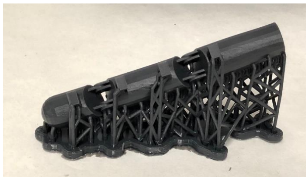
Imatge 63: Model de dit articulat imprès per estereolitografia amb les estructures de suport. Font: pròpia.
