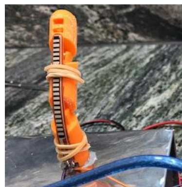
Imatge 94: Flex sensor unit al model del dit de plàstic. Font: pròpia.
