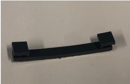
Imatge 66: Model de dit pla imprès per estereolitografia. Font: pròpia.
