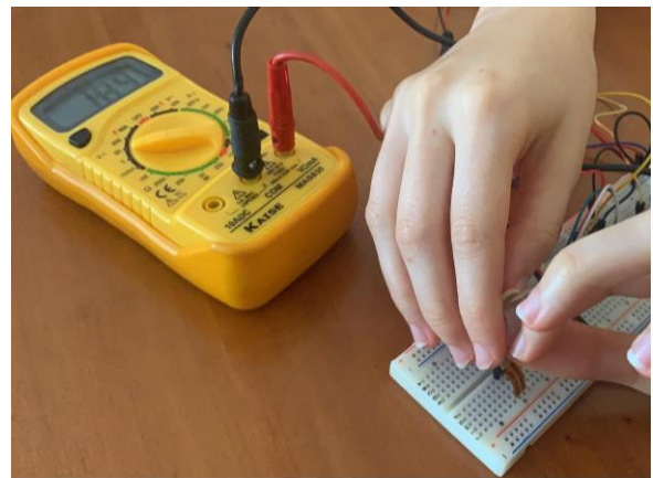
Imatge 104: Valor del voltatge doblegant el model amb el flex sensor unit al dit pla 50%. Font: pròpia.
